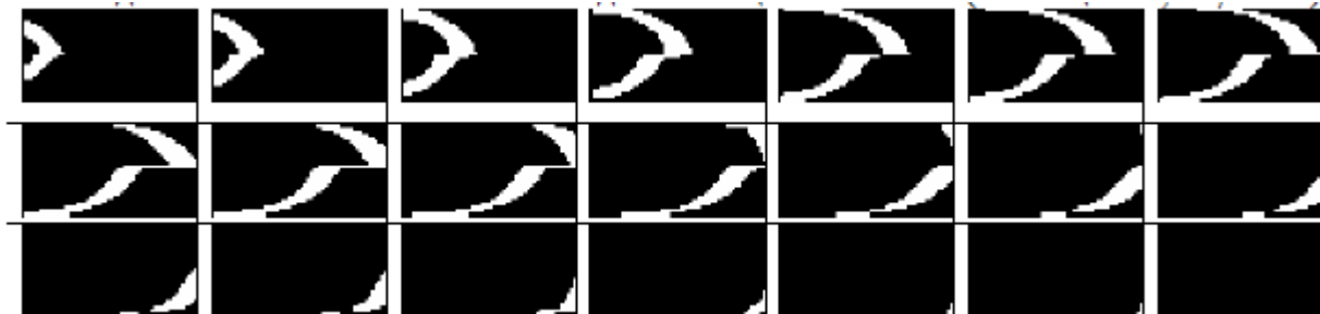
Последовательность движения оторочки трассера в пласте от нагнетательной к добывающей скважине
