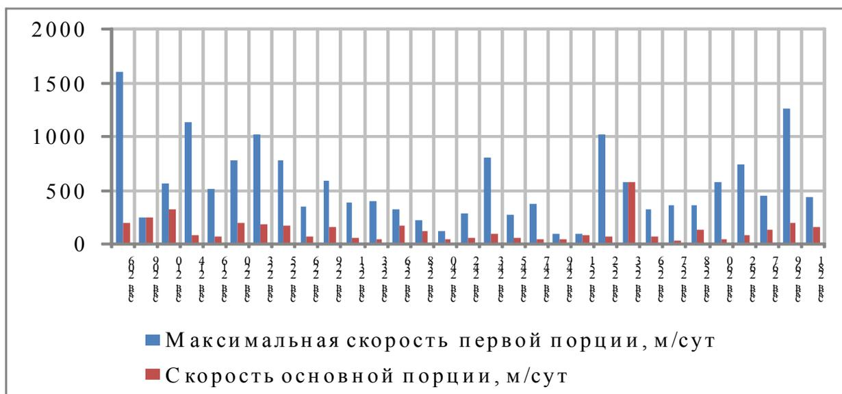
Рисунок В.6 - Скорости перемещения фильтрационных потоков от нагнетательной скважины 248 Южно-Хыльчююского месторождения
