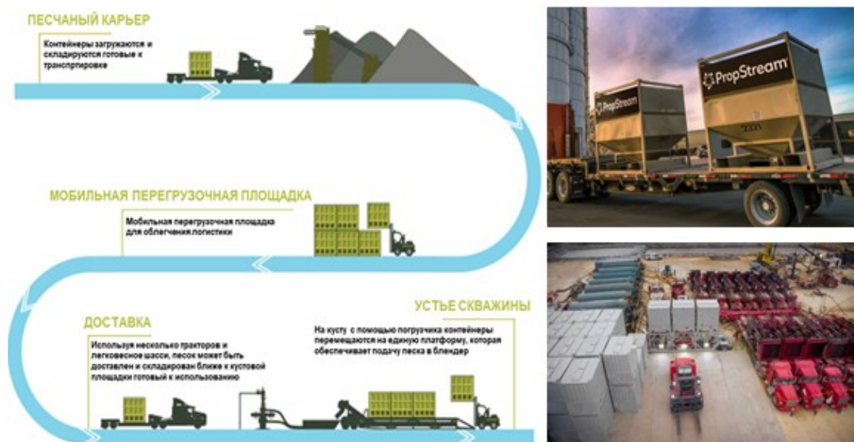
Рисунок 51 – Силосные емкости на кустовой площадке [31]
