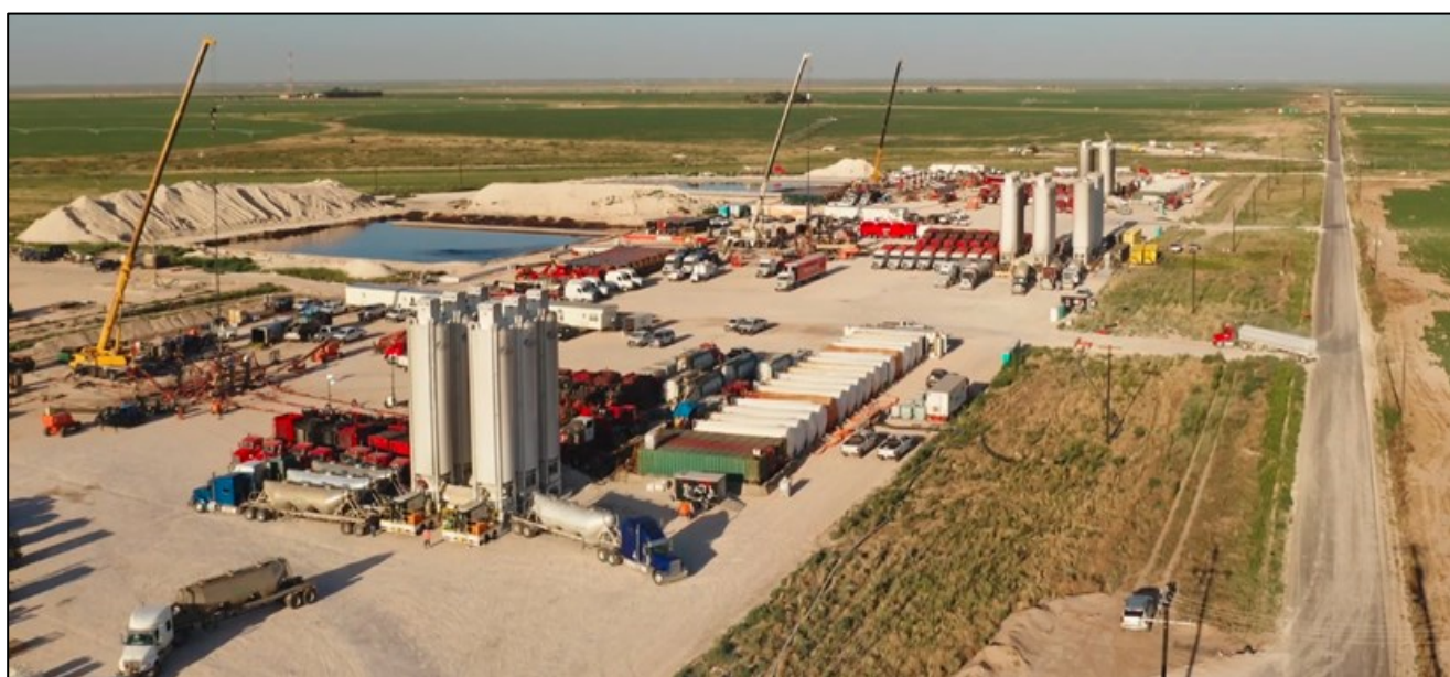
Рисунок 51 – Силосные емкости на кустовой площадке [31]
