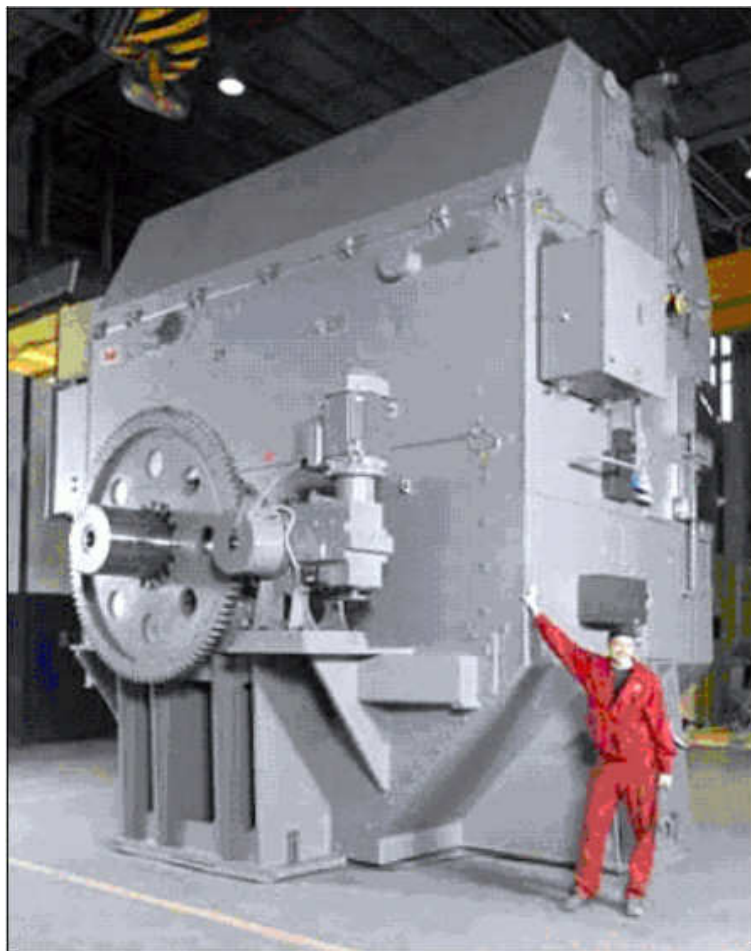
Рисунок 3.26: Привод компрессора с номинальной мощностью 24 МВт
