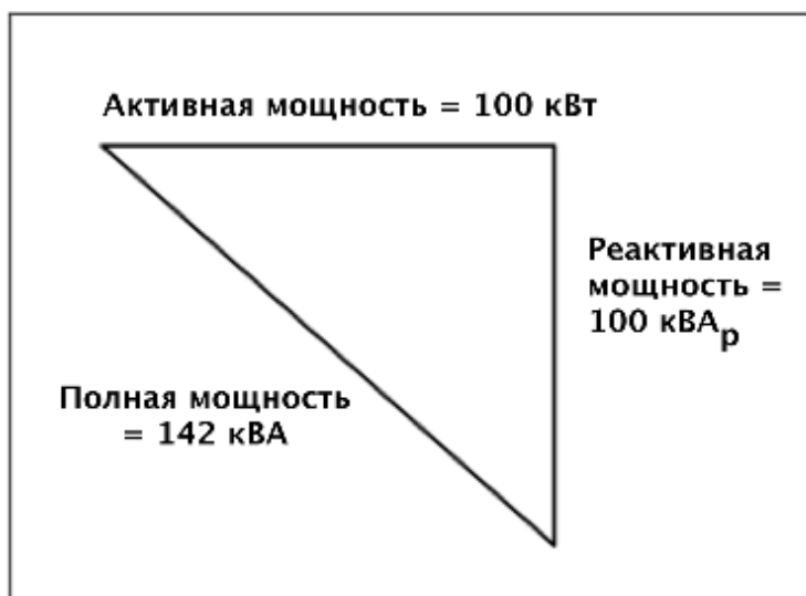
Рисунок 3.22: Активная, реактивная и полная мощность
