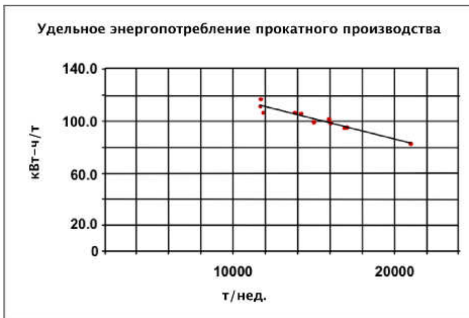
Рисунок 7.12: Удельное энергопотребление прокатного производства в зависимости от объема выпускаемой продукции
