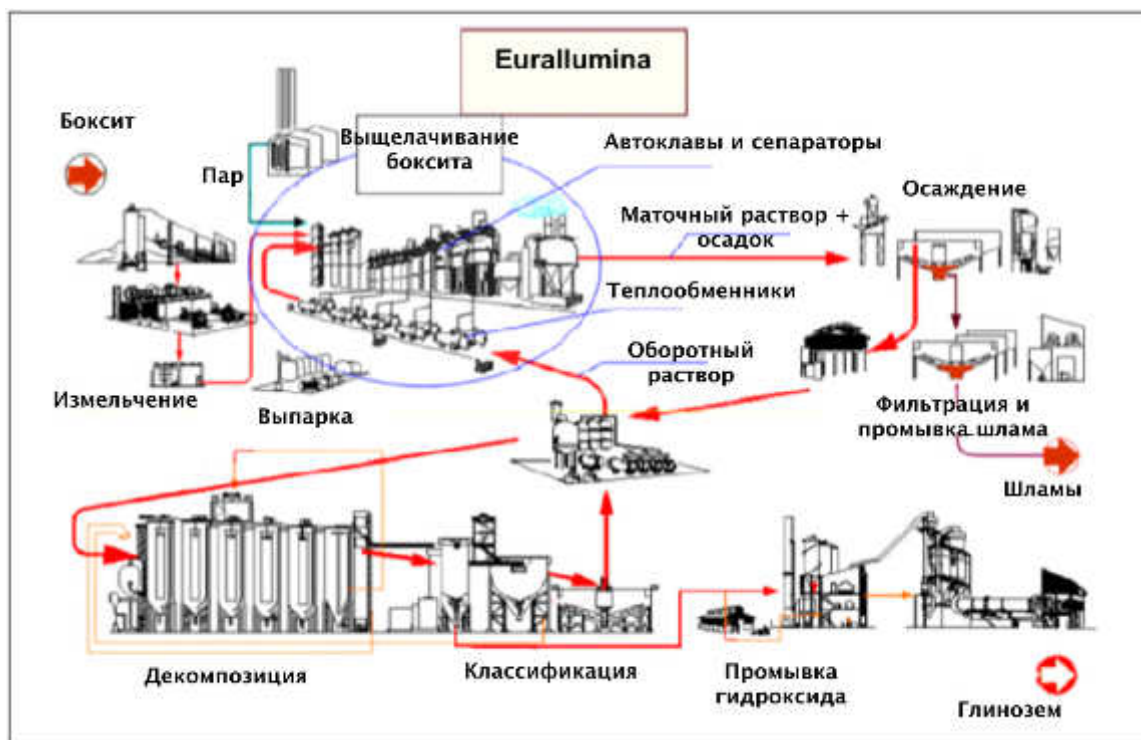
Рисунок 7.14: Схема технологического процесса глиноземного завода Eurallumina [48, Teodosi, 2005]
