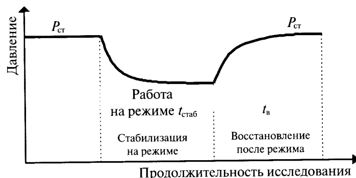
Рисунок 8.3 – Полный цикл изменения давления во времени на одном режиме исследования
