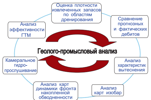
Рис. 3. Блок геолого-промышленного анализа. Итерационная схема построения оптимальной геолого-гидродинамической модели. 1 – стандартный граф. обработки, 2 – адаптация гидродинамической модели не исправляет ошибок, сделанных на предыдущих этапах, а добавляет новые, 3 – предлагаемая схема обработки.
