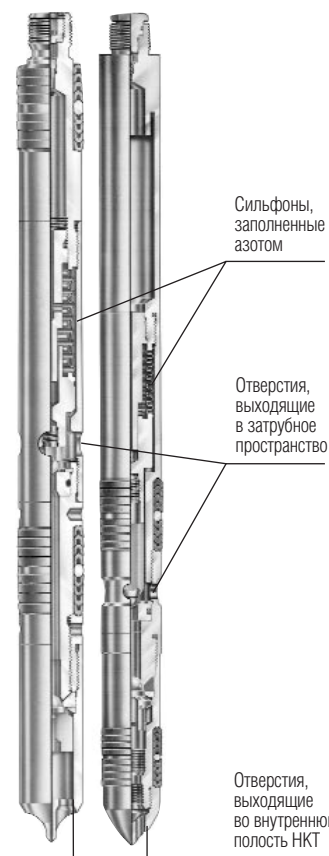
Рис. 9. Скважинные газлифтные клапаны. Выбор клапана и принципа эксплуатации зависит от характеристик скважины и затрат на спуск инструментов в скважину. Обычные газлифтные клапаны и камеры для них спускаются в составе эксплуатационной колонны насосно-компрессорных труб. Съемные клапаны в камерах с боковым карманом, которые смещены относительно осевой линии насосно-компрессорных труб, применяются на морских и отдаленных месторождениях, где использование буровой установки для извлечения эксплуатационной колонны сопряжено со значительными затратами. Для клапанов, срабатывающих под действием давления, усилие, необходимое для удержания клапана в закрытом положении, обеспечивается пружиной или сильфоном, заполненным азотом, либо обоими вместе. На наземном испытательном стенде клапаны настраиваются на открытие при требуемом для скважины рабочем давлении. В условиях ограниченных зазоров и в скважинах малого диаметра применяются клапаны с уменьшенным наружным диаметром.
