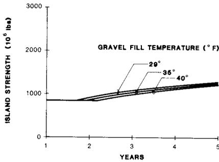
Fig. 9 ISLAND STRENGTH vs GRAVEL FILL TEMPERATURE
