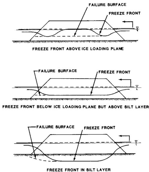
Fig. 1 GRAVEL ISLAND FAILURE MODE
