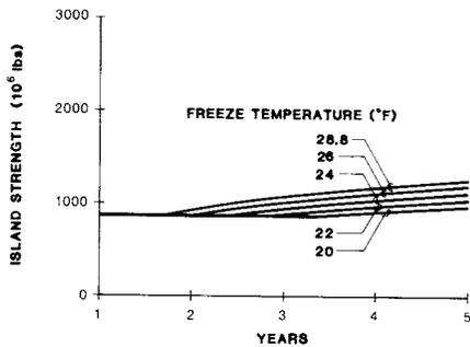
Fig. 11 ISLAND STRENGTH vs FREEZE TEMPERATURE
