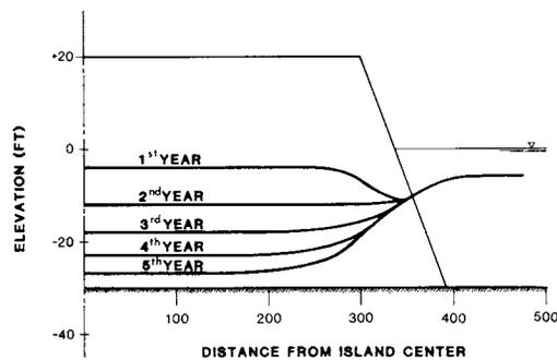
Fig. 4 FREEZE FRONT PROPAGATION WITH TIME
