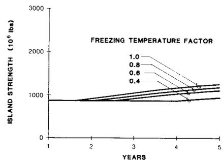
Fig. 14 ISLAND STRENGTH vs INCREASE GROUND SURFACE TEMPERATURE
