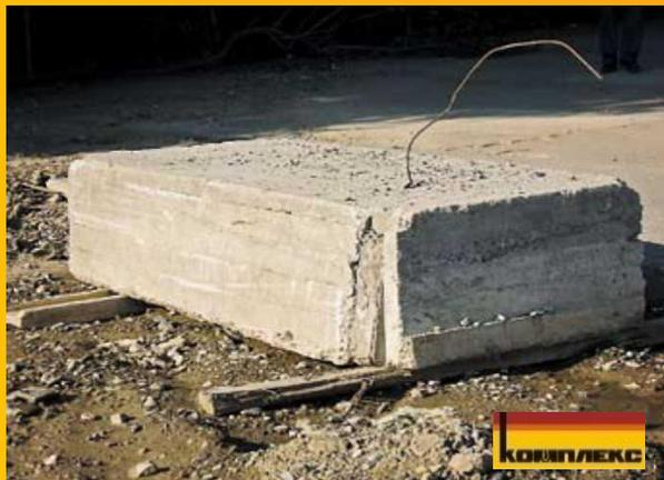
Для проведения испытаний по эффективности гидромониторных насадок щелевого перфоратора изготовлен бетонный блок из прочного цемента марки 400, который находился в ожидании капитального схватывания в течение одного месяца в идеальных условиях.
