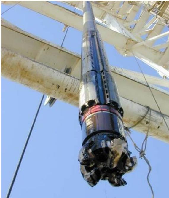
Система для вертикального бурения Rotary Steerable Systems (ZBE RSS)
