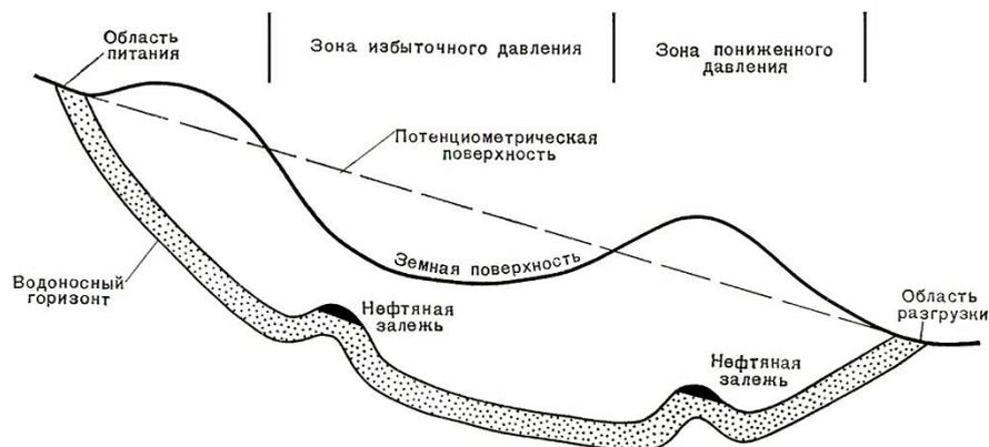
Рисунок 1. Механизм гидравлического условия залегания наклонных залежей нефти и газа
