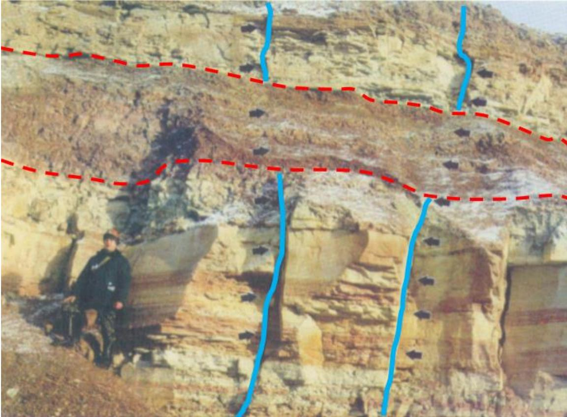
Рисунок 14. Пример обнажения с затуханием трещин в пластичном глинистом прослое
