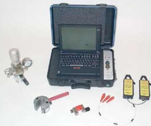
Для записи и анализа данных используется портативный компьютер, смонтированный вместе с высокоточным аналогово-цифровым преобразователем в жестком переносном футляре. Применение единого электронного блока с необходимыми датчиками для возможности анализа всех параметров скважины позволяет добиться значительной экономии.
