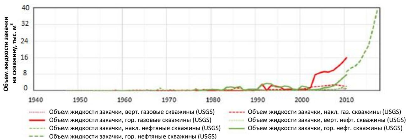
Рисунок 21 – Динамика изменения объема жидкости ГРП, приходящегося на одну скважину
