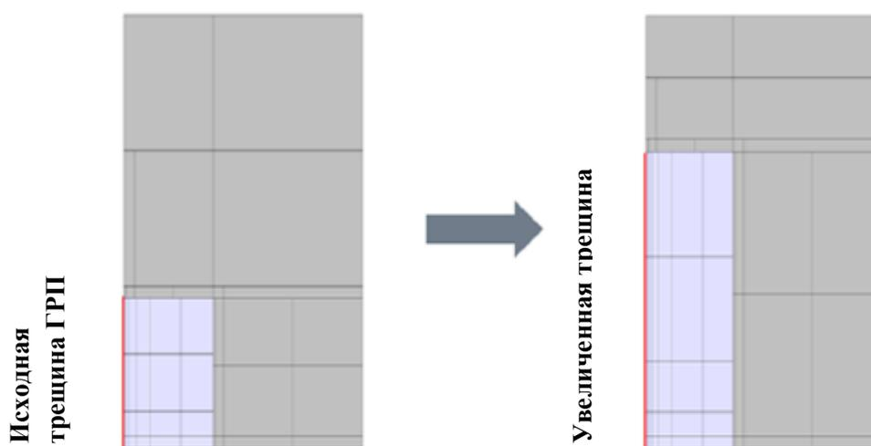
Рисунок 36 – Модель «Refrac Extension» увеличивает первоначальную длину трещины ГРП после проведения рефрака (также опционально можно изменить k)
