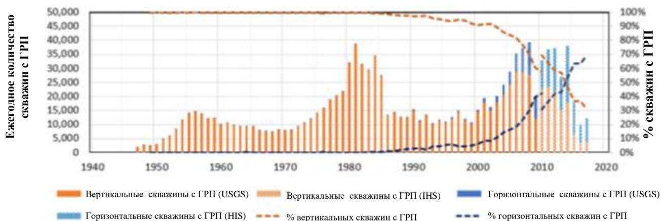
Рисунок 28 – Динамика изменения количества горизонтальных и вертикальных скважин в США
