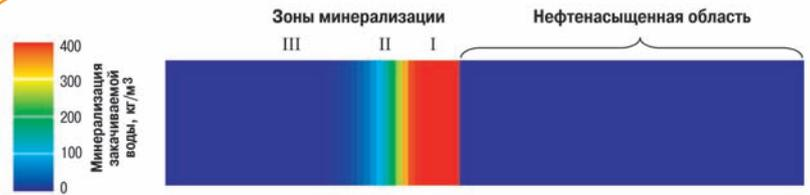
Рис. 4. Минерализация воды закачки в процессе вытеснения
